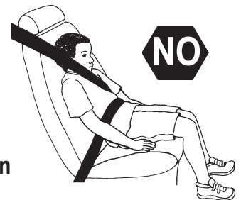
Cinturón de seguridad mal ajustado. Niño es demasiado pequeño para usarlo con seguridad.
